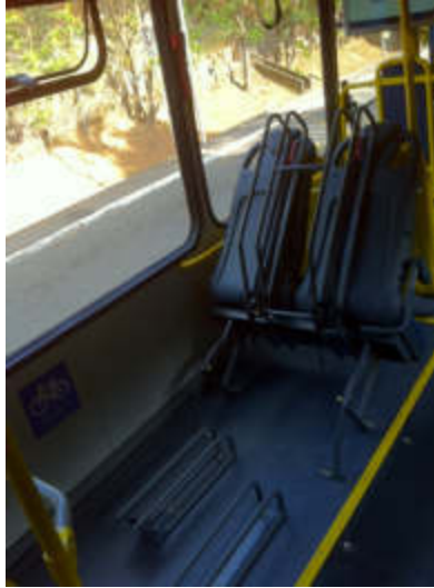
Figuras 09: Ônibus em Belo Horizonte adaptado para bicicleta (Fonte: Empresa de Transportes e Trânsito de Belo Horizonte - BHTRANS).
