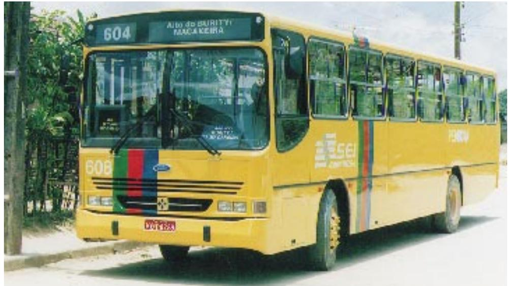
O ônibus Padron foi o primeiro projeto desenvolvido no Brasil de um veículo com condições superiores de operação, visando oferecer mais conforto aos usuários. Piso rebaixado, três portas de folha dupla, transmissão automática são alguns dos itens que o diferenciam dos ônibus comuns. Todas as grandes cidades brasileiras já o adotam em linhas troncais.
