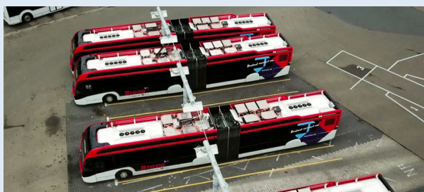
Figura 21: Ônibus elétrico em ponto de recarga rápida na cidade de Oslo, 2018.
