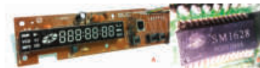
Figura 2. (A) Placa com display retirada de um aparelho de DVD, (B) Detalhe do circuito integrado SM1628, no verso da placa.
