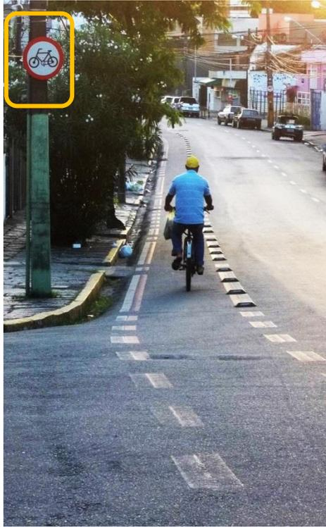
Figura 49: Sinalização Vertical de Regulamentação R-33. Trecho: Estrada do Arraial. Fonte: Dados da pesquisa (M.D.INÁCIO, 2013).
