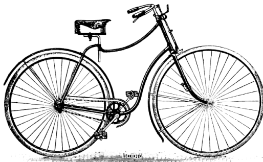
“Bicicleta de segurança”, de 1885, já bem parecida com o modelo que conhecemos hoje.
