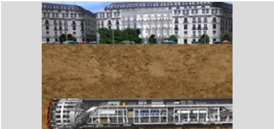
FIGURA 5 – Tuneladora escavando o túnel de Metrô abaixo da superfície
