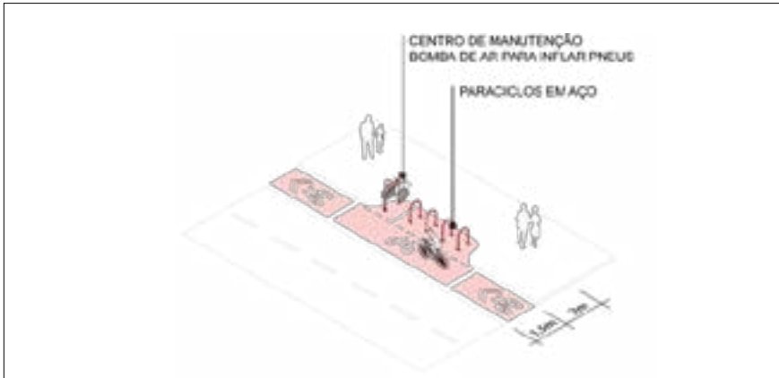
FIGURA 10: Espaço público de manutenção e estacionamento de bicicletas
