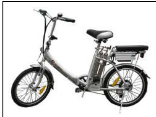
Figura 2.6: Bicicleta híbrida com célula combustível de hidrogênio. Fonte: <www.pearlhydrogen.com>, 2009.
