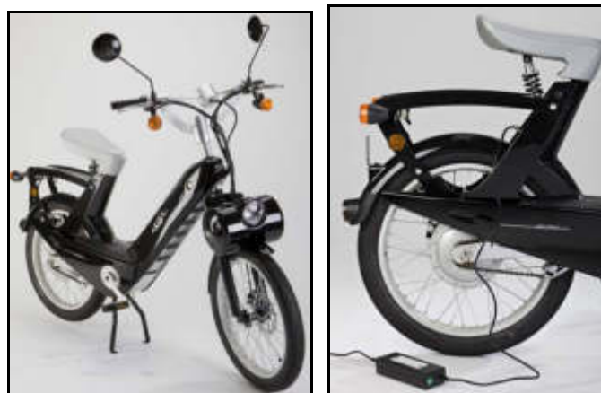
Figuras 2.4 e 2.5: Bicicleta elétrica - E-Solex, modelo 2.0. Fonte: < www.e-solex.fr >, 2009.
