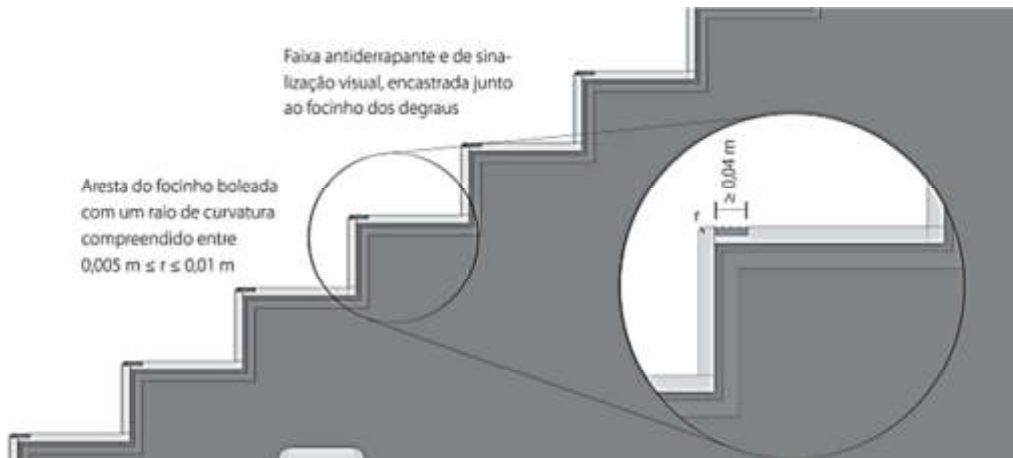
FIGURA 16. Pormenor de degrau (Teles, 2007)
