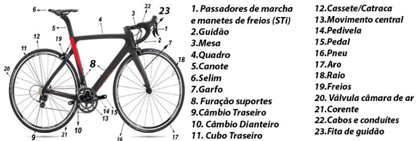
Figura 1 - Bicicleta speed (roda livre com marchas) e seus componentes
