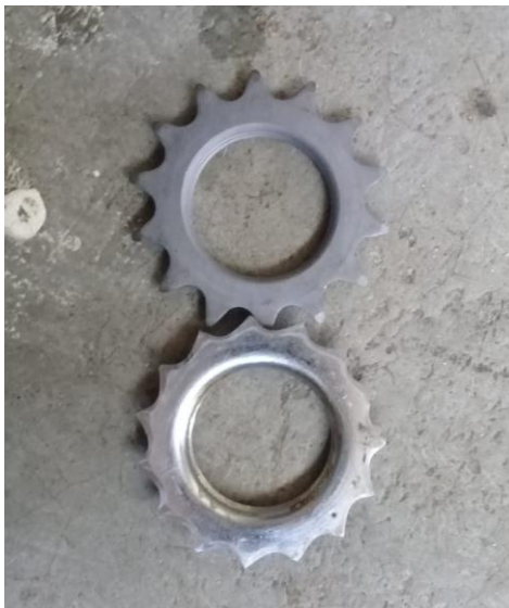
Figura 11 - Diferença de desgaste dos dentes dos pinhões do Antônio no período de um ano (pinhão novo acima, pinhão velho abaixo)
