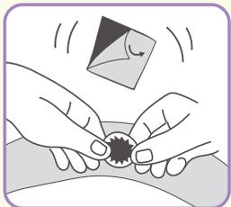
**6º passo:** retire o plástico prata do remendo, coloque uma fina camada de cola e espere secar por um minuto. Em seguida, coloque o remendo sobre a câmara, deixando o furo no meio e pressione do meio para as bordas. Retire um lado do plástico por vez, sempre do meio para fora. Verifique se as bordas do remendo estão devidamente coladas. Aguarde pressionando uns minutos para o remendo fixar totalmente na câmara.
