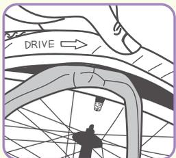
**8º passo:** verifique o lado correto para encaixar o pneu no aro. Nele há uma seta com a indicação da direção correta para inserir. Encaixe um dos lados do pneu no aro.
