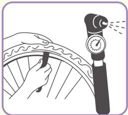
**9º passo:** para facilitar a colocação da câmara dentro do pneu, e para que não dobre ao ser inserida, inicie sua colocação pela válvula. Com a câmara inserida, encaixe o outro lado do pneu no aro, começando também pela válvula. Pressione a parede do pneu sobre o aro com os polegares ou as espátulas para encaixá-lo em toda a extensão.
