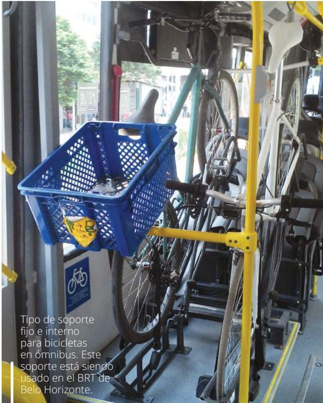
Tipo de soporte fijo e interno para bicicletas en ómnibus. Este soporte está siendo usado en el BRT de Belo Horizonte.
