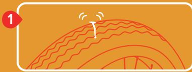
**1** Veja se consegue observar o local do furo. Muitas vezes é difícil com a câmara no interior do pneu. Se não identificar, o ideal é retirá-la inteira para observar o local exato. A câmara deve estar totalmente vazia para ser retirada.
