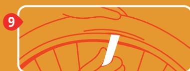
**9** Encaixe novamente o pneu na parte interna da roda.
