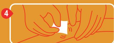
**4** Lixe a superfície em que está o furo para aderência da cola e do remendo.
