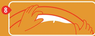
**8** Insira novamente a câmara na parte interna do pneu.
