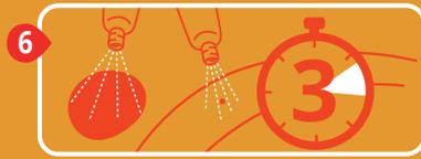
**6** Aplique cola na superfície do remendo e na área próxima ao furo. Aguarde cerca de 3 minutos e aplique-o na área central do furo.
