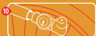
**10** Encha o pneu com a calibragem adequada para o seu modelo de bicicleta.
