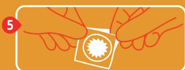
**5** Retire o remendo que será utilizado para ser colocado sobre a superfície do furo.
