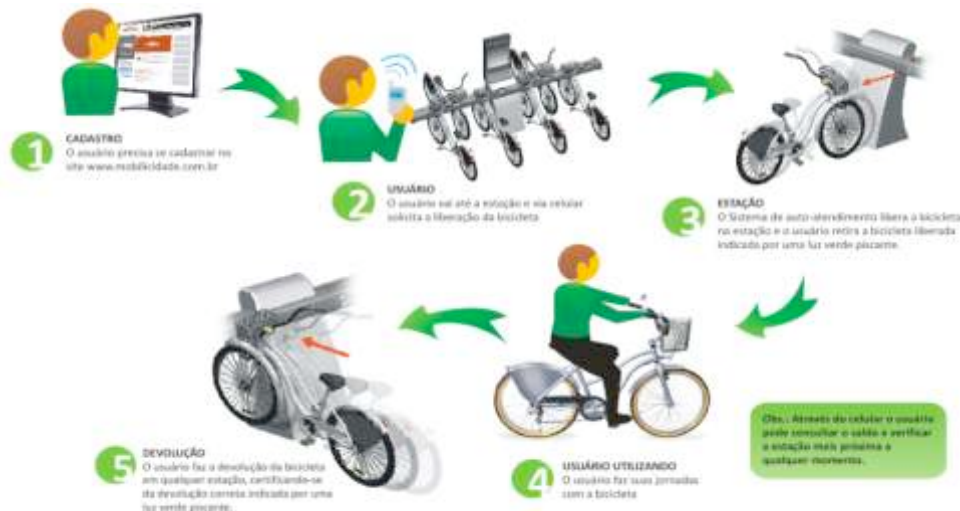
Figura 15 . Diagrama explicativo de operación. Fuente: Serttel Ltda
