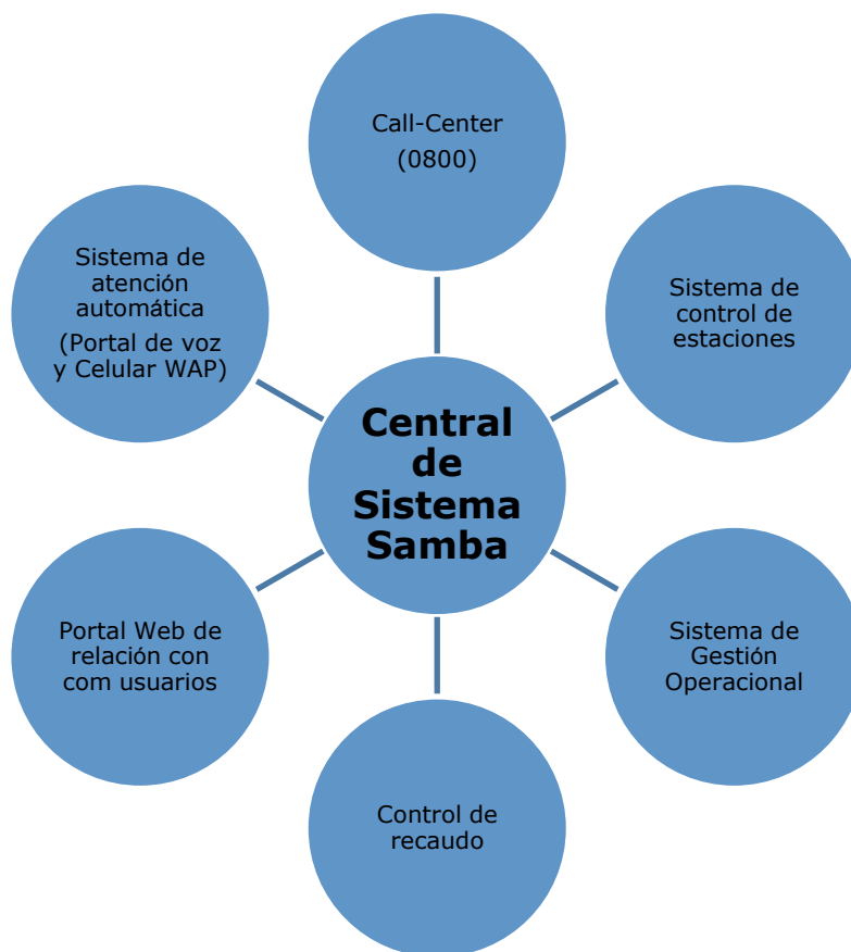
Figura 16 Diagrama de componentes del sistema. Fuente: Serttel Ltda.
