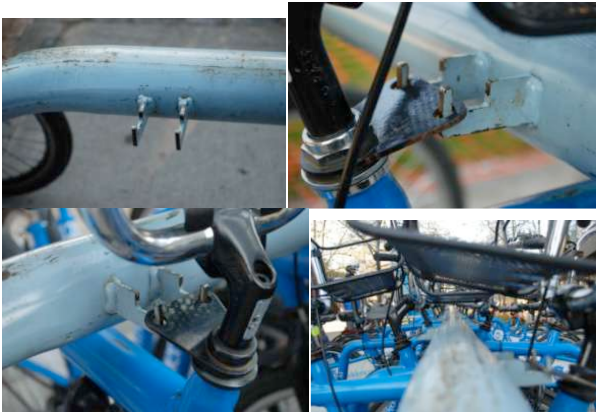
Figura 25. Detalles de enganche de la bicicleta. Foto por CarlosFelipe Pardo.
