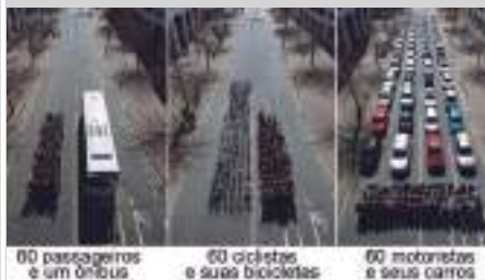
Figura 3 - Espaço viário ocupado pelo mesmo número de pessoas em 3 modais diferentes: ônibus, bicicleta e carro. Fonte: Mobilidade Urbana Sustentável (2013).
