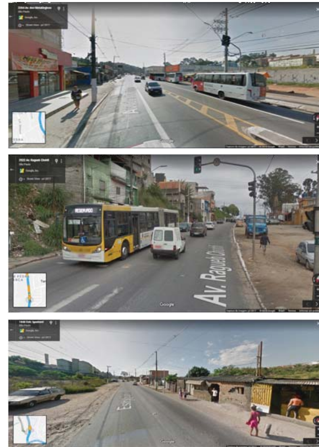
Figura 1 Exemplos do viário: (a) Avenida dos Metalúrgicos, ligação com Guaianases: tráfego intenso de ônibus e caminhões. (b) Av. Ragueb Chohfi, ligação com São Mateus: tráfego intenso de ônibus, caminhões e ausência de calçadas. (c) Estrada do Iguatemi, ligação com Guaianases: via arterial bidirecional com apenas uma faixa de rolamento, ausência de calçadas e construções próximas ao leito da via
