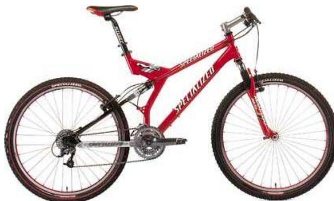
Bicicleta de montanha com suspensão dianteira e traseira.
