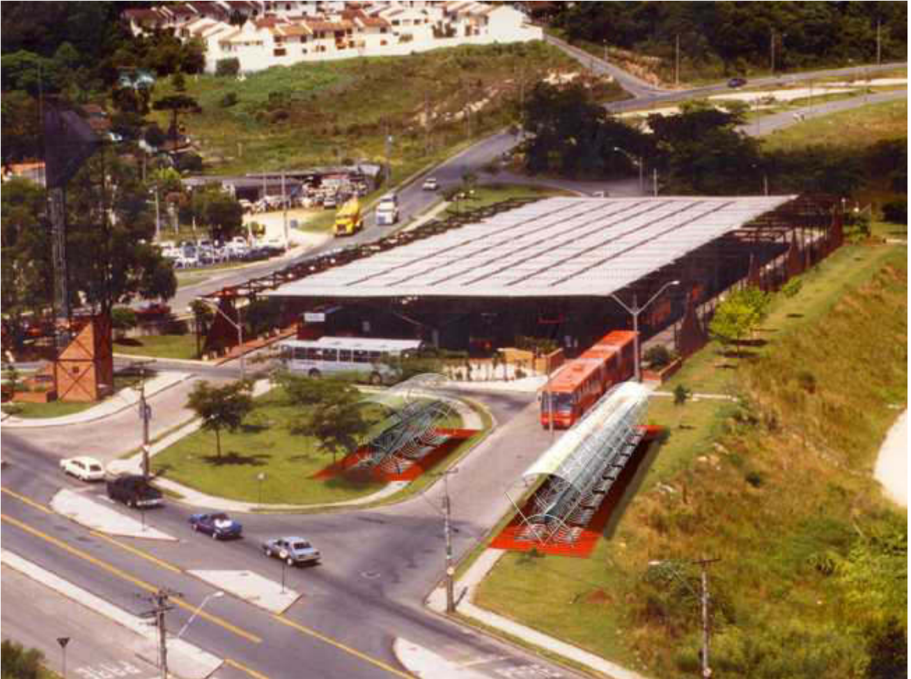
fig. 252 - ilustração de implantação de 12 módulos de 13 vagas no terminal do Santa Cândida
