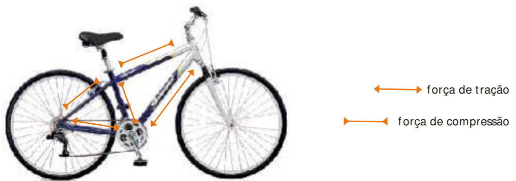
forças atuantes no quadro de uma bicicleta MTB
