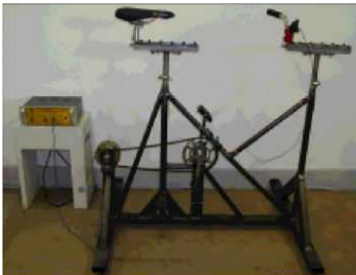
fig. 101 - SIMULADORES desenvolvidos para estabelecer relações entre o corpo humano, eficiência, conforto e geometria de quadros. (Delft University of Technology, Holanda e Tatung University, Taiwan)
