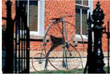
roda elevada, raios metálicos 1870
