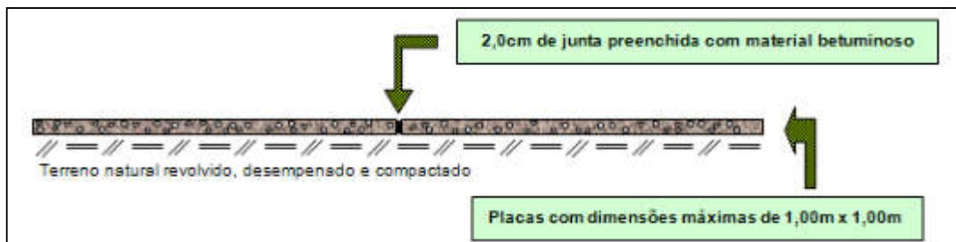
Figura 3.9 – Pavimento de Concreto em Placas Pré-Moldadas (GEIPOT, 2001)
