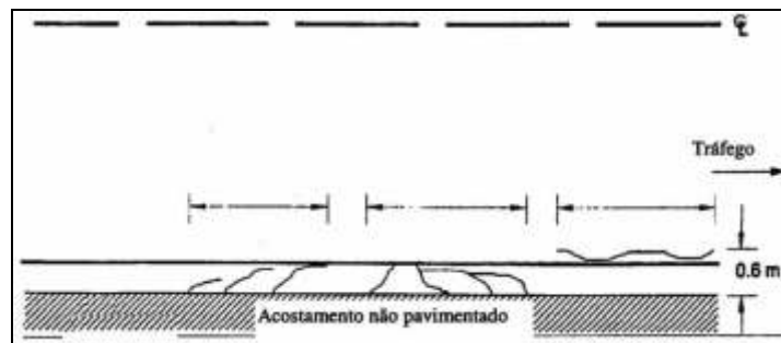
Figura 3.20 – Trincamento na borda (DNER, 1998)
