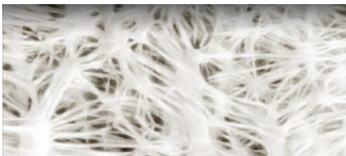
Figura 12: Imagem microscópica da membrana de teflon Gore-tex®.
