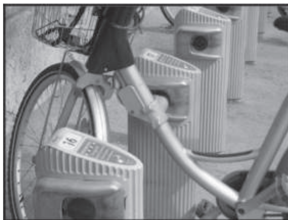
Imagem 4.3 - Detalhe da fixação da bicicleta. Foto: Mariana Veloso, 2006
