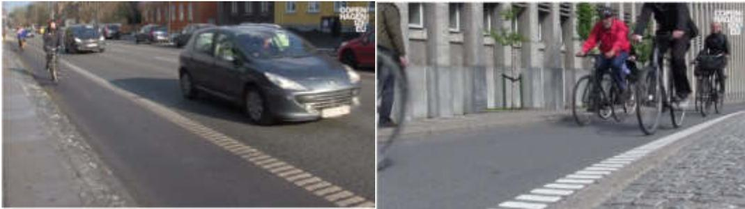
Imagem 15: Marcação através de pintura. Imagem 16: rebaixamento da faixa em relação à via
